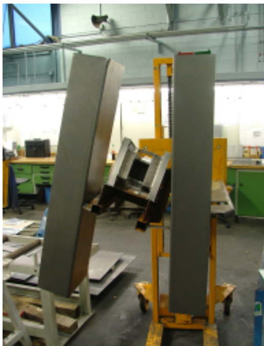
Bild 1.5: Vorbereiteter Schweißversuch mit eingeschränkter Bewegungsmöglichkeit für den Schweißer
