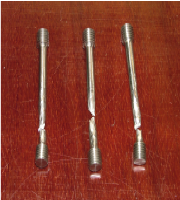
Bild 1.4: Zerstörte Zugproben nach Zugverzug bei 77°K
