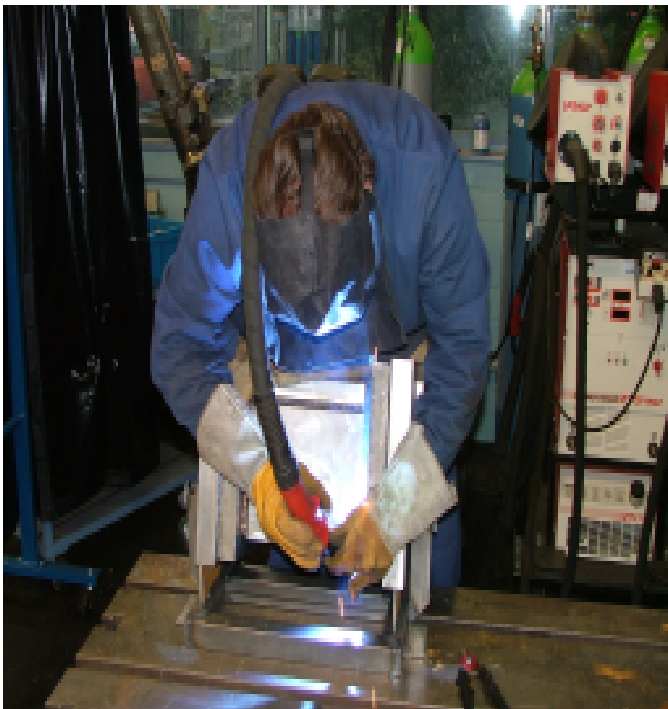
Bild 1.3: Maßstabsgerechte Nachbildung einer Druckstütze im Schweißversuch
