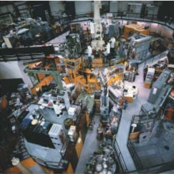
Neutronenstrahlen werden in Forschungsreaktoren durch Kernspaltung erzeugt und in speziellen Geräten, so genannten Spektrometern, auf die zu untersuchenden Proben gelenkt. Neutronen sind elektrisch neutrale Bausteine der Atomkerne. An den Atomen und Molekülen der Proben „prallen“ sie ab; ähnlich Billardkugeln ändern sie dabei ihre Richtung und Geschwindigkeit. Die Art der „Streuung“ gibt Auskunft über die Anordnung der Atome und deren Verhalten in der Probe.
