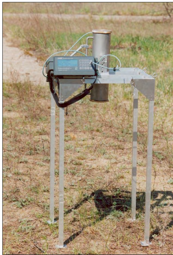
Abbildung 1-7: Bodenmessung (Ortsdosis) mit dem Messsystem MAB500
