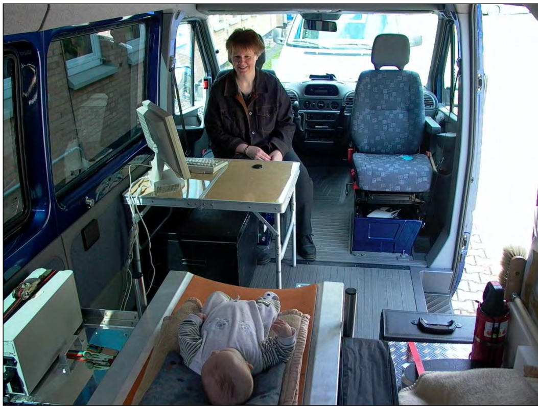
Foto 2 : Messfahrzeug des Forschungszentrums Jülich mit Ganzkörperzähler und Auswerteeinheit
