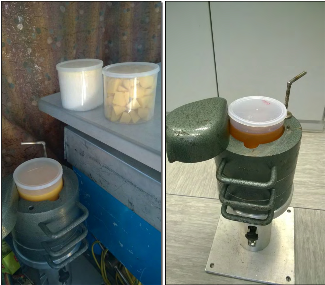
Abbildung 1-8: Lebensmittelmessgerät mit NaI(Tl)-Detektor und Bleiabschirmung
