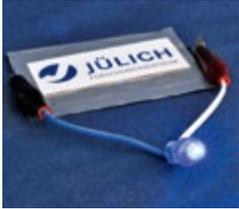
Im Labormaßstab funktioniert die Festkörperbatterie der Jülicher Wissenschaftler schon erstaunlich gut. Als Elektrolyt hat sie eine Spezialkeramik anstelle einer Flüssigkeit. Das verringert Probleme wie Auslaufen, Überhitzen, Abbrand und Giftigkeit.
