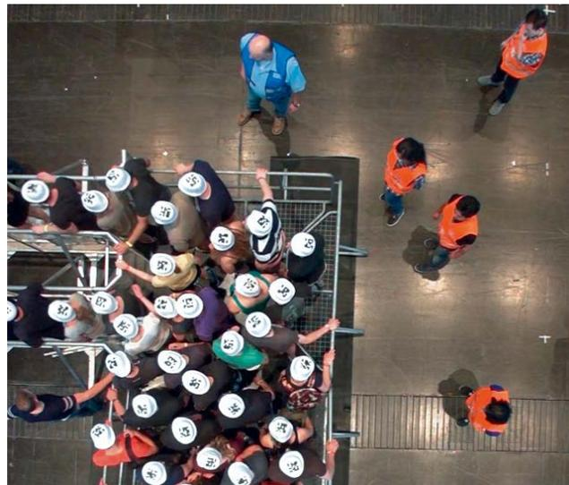
**Gedränge im Experiment: Eingangsbereich zu einer Veranstaltung mit künstlicher Einengung durch Absperrgitter.**
