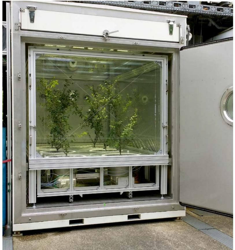
**Die dynamische Pflanzenklimakammer SAPHIR-PLUS wird für die Untersuchung von biogenen Kohlenwasserstoffemissionen und ihren Einfluss auf atmosphärenchemische Prozesse eingesetzt.**
