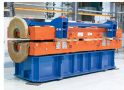
Der erste von insgesamt 44 Dipolmagneten für den Beschleuniger HESR trifft in Jülich ein. Jeder von ihnen ist mit über 34 Tonnen ähnlich massig wie ein Schwerverlaster. Entworfen und geplant in Jülich, gebaut von einem französischen Unternehmen, sollen die Magneten später den Teilchenstrahl im HESR auf Kurs halten. Dieser Ring ist der wesentliche Jülicher Beitrag für den Beschleunigerkomplex FAIR in Darmstadt.
