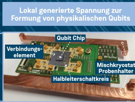
Prototyp eines Versuchsaufbaus zur Integration des Qubit-Chips und des Halbleiterschaltkreises
