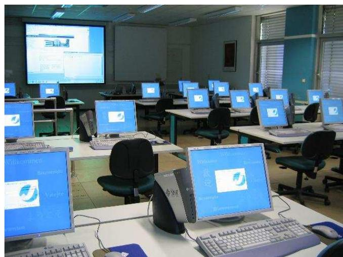
Die Sun Ray Systeme besitzen keine lokalen Daten und kein Betriebssystem. Dadurch reduziert sich der Wartungsaufwand. Die Desktopumgebung und die Anwendungen werden von einem zentralen Server (Opteron-Multi-Prozessor-
