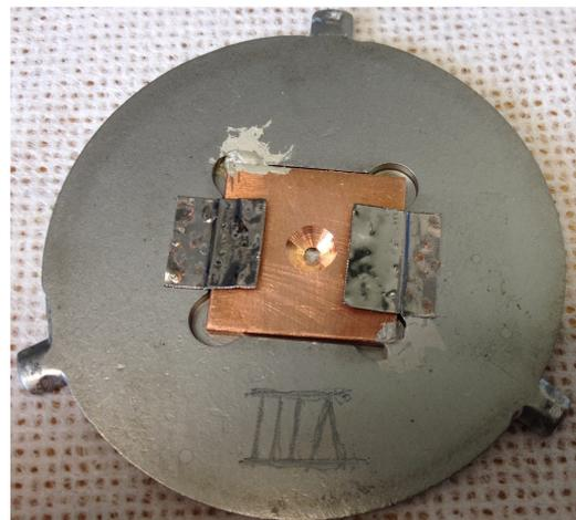
**Abbildung 5.5:** a) Intensitätsverlauf beim Verfahren des Elektronenstrahls über das Pinhole bei einer Fokus-Einstellung von 3,25 und Anpassung der erhaltenen Funktion an den Intensitätsverlauf. b) Foto der Probe mit dem Pinhole
