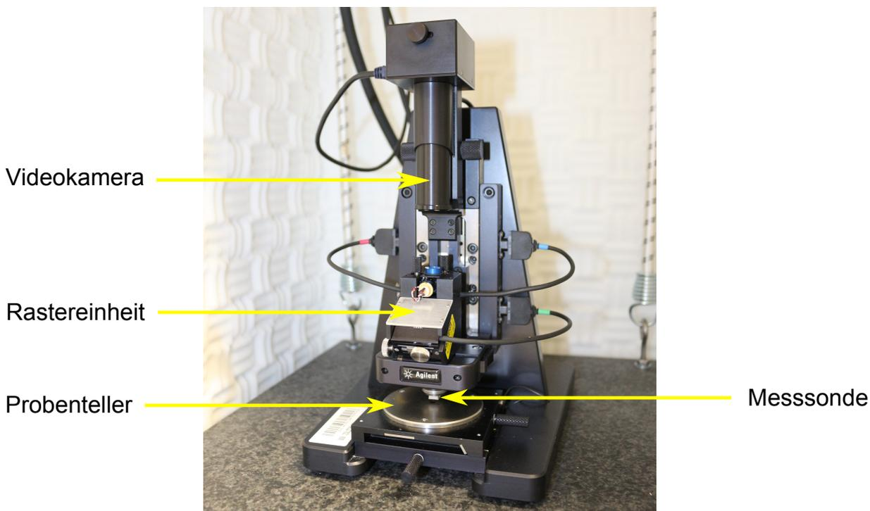
Abbildung 12.: Die dargestellte Aufnahme zeigt das verwendete AFM der Firma Agilent, Modell 5420. Der Aufbau befindet sich auf einer Marmorplatte, die im Innern der gedämmten Kammer an vier Federn befestigt ist, um äußere Störeinflüsse zu reduzieren.
