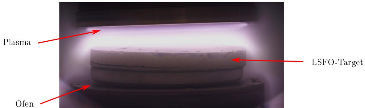
Abbildung 6.2.1.: Die Versilberung eines Targets für eine bessere thermische Kontaktierung beim späteren Sputtern. In der Sputteranlage wird das Target bei einer Temperatur von  $750\text{ }^{\circ}\text{C}$  unter einer Argonatmosphäre mit etwa  $1\text{ }\mu\text{m}$  Silber beschichtet. Aufgrund einer zu schnellen Heizrate hat sich bei diesem Target ein Riss an der Unterkante gebildet.
