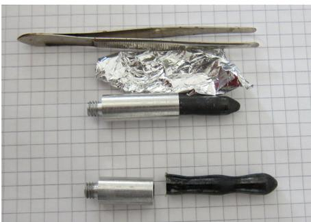
**Abbildung 3.1:** Die beiden verwendeten Kristalle, oben  $hhl$ -Kristall und darunter der  $hk0$ -Kristall. Hier mit den Halterungen für das Dreiachsenspektrometer PANDA.
