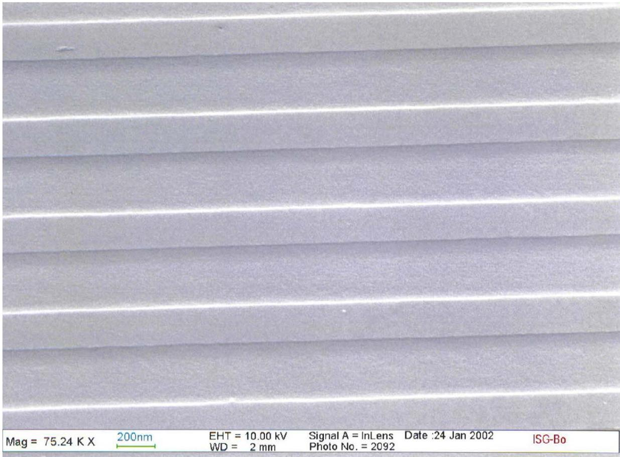
Abb. 1.1 : REM – Aufnahme einer nanostrukturierten Probe (Oberfläche, unter einem Winkel von 60 °)
