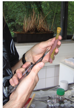
Abbildung 5.2: Das komprimierte Pulver wird dem Gummischlauch entnommen.
