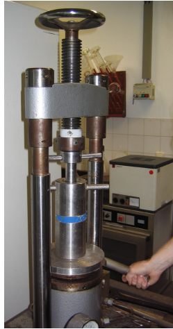
Abbildung 5.1: Die hydraulische Presse zur Verdichtung des pulverförmigen Materials.
