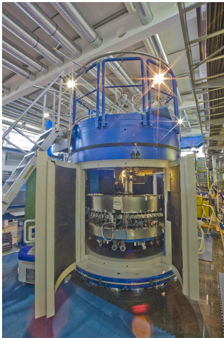
Abbildung 4.3: Außenansicht des DNS. Im Gerät sieht man die Detektorbank von hinten.
