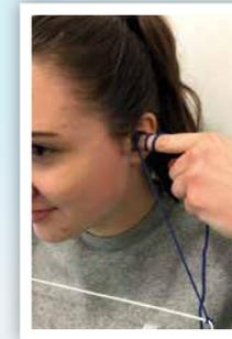
Mit den Fingern in den Ohren schwingst du den Bügel gegen die Tischkante.
