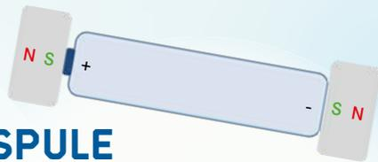
Wer große Eisenbahnen mag, wird diese kleine lieben! Sie bewegt sich fast wie von Zauberhand durch einen aus Draht gewickelten Tunnel. Natürlich ist das kein Zaubertrick – sondern Elektromagnetismus!
