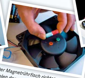
Der Magnetrührfisch richtet sich nach den Polen der aufgeklebten Magnete aus.
