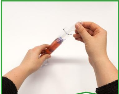
Pipette mit Alginat - Lösung füllen
