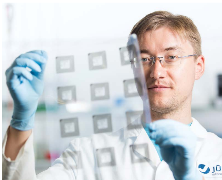
↑ Den Erfolg vor Augen: Alexey Yakushenko begutachtet die auf eine Folie aufgedruckten hauchdünnen Funketiketten.
