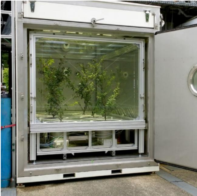
**Die dynamische Pflanzenklimakammer SAPHIR-PLUS wird für die Untersuchung von biogenen Kohlenwasserstoffemissionen und ihren Einfluss auf atmosphären-chemische Prozesse eingesetzt.**
