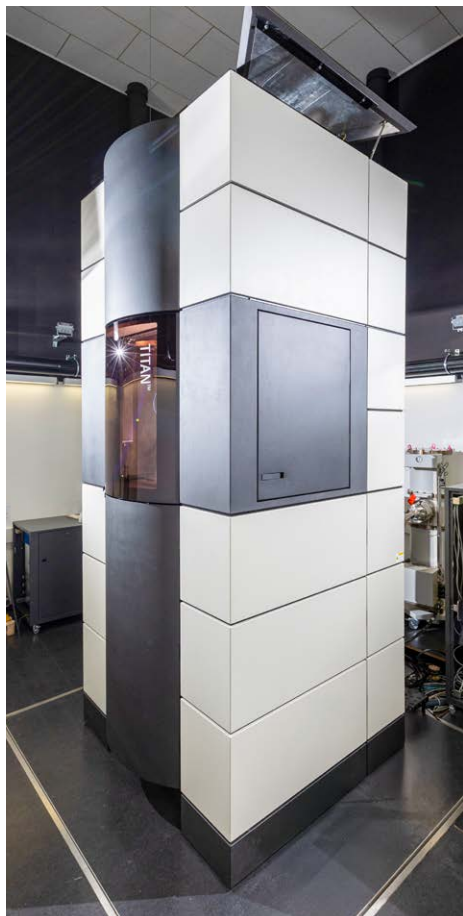
Das Elektronenmikroskop PICO kann atomare Strukturen mit einer Rekordauflösung von 50 Milliardstel Millimeter untersuchen.
